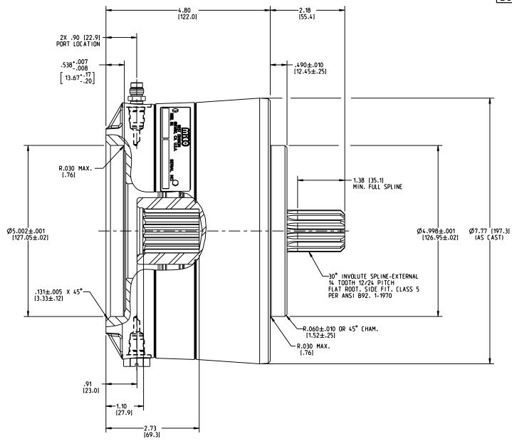
1. USE MINERAL BASE HYDRAULIC OIL ONLY FOR BRAKE RELEASE.
