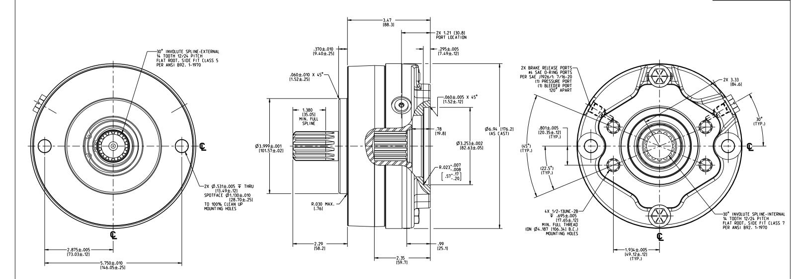
1. USE MINERAL BASE HYDRAULIC OIL ONLY FOR BRAKE RELEASE
