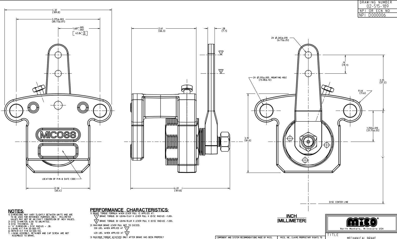
BRAKE TORQUE: Bt (LBIN)=10.69 X LEVER PULL X (DISC RADIUS -1.00).
