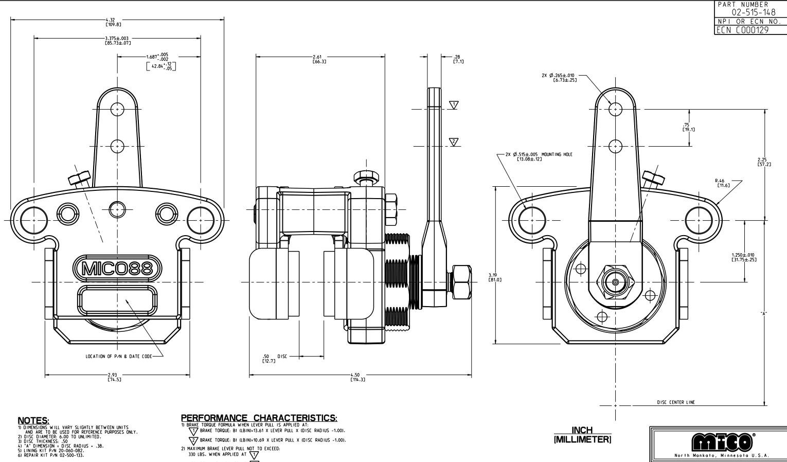
BRAKE TORQUE: Bt (LBIN)=10.69 X LEVER PULL X (DISC RADIUS -1.00).
